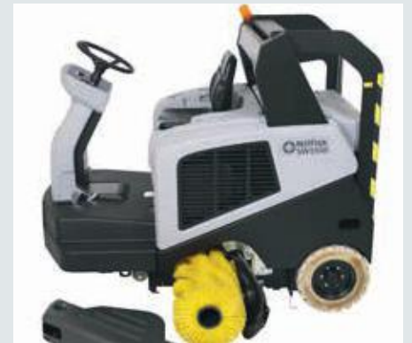
Schnelles und einfaches werkzeugloses Austauschen der Hauptkomponenten vereinfacht die täglichen Arbeitsabläufe und reduziert die Stillstandszeiten.
