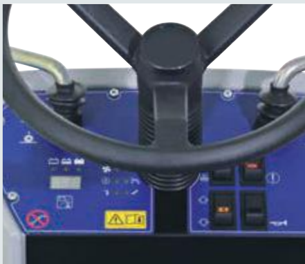
Die SW4000 spart Energie und Material durch automatisch anhaltende Besen im Stillstand.
