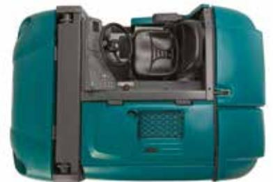
Hervorragende Ergebnisse in den unterschiedlichsten Umgebungen mit doppelten Seitenbesen, die in Kombination mit dem großen 395 l Duramer™-Kehrgutbehälter eine Kehrbreite von bis zu 2030 mm in einem einzigen Arbeitsgang ermöglichen.
