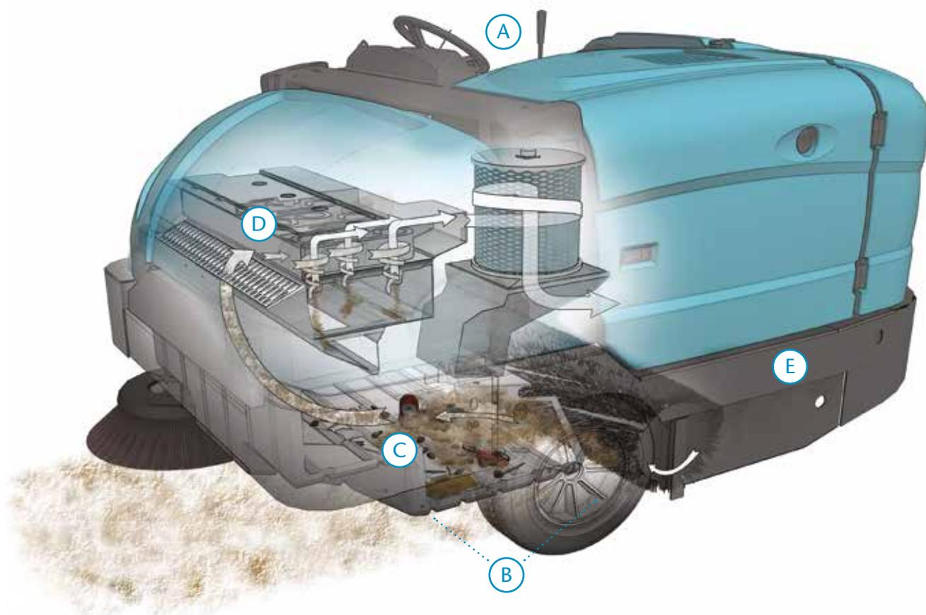
**A** Wirksames Entfernen verschiedenster Arten von Verschmutzung mit dem II-Speed™-Kehrsystem. Hierbei wird die Drehzahl der Hauptkehrwalze, des Seitenbesens und des Saugventilators um 20 % erhöht.
