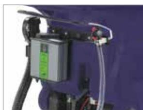
Füllstandsanzeige des Lösungsmitteltanks und Ablassschlauch
