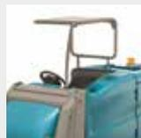
**FOPS-zertifiziertes** Fahrerschutzdach zum Schutz des Bedieners vor herabfallenden Objekten.
