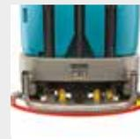
**Der Saugfußschutz auf der Rückseite** verhindert Beschädigungen des Saugfußes.
